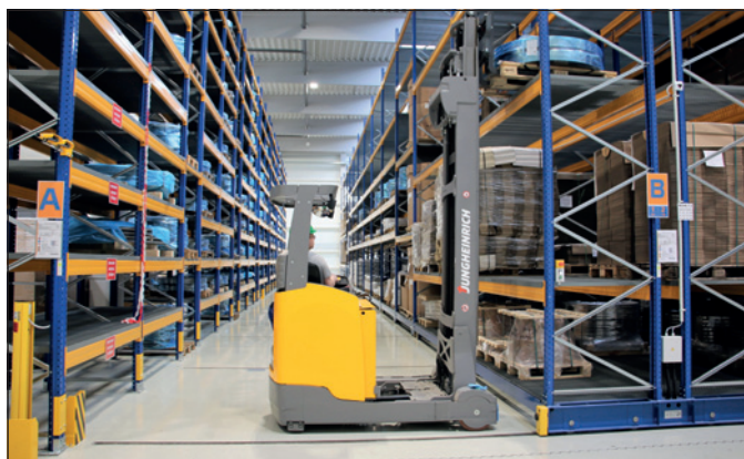
Automatizovaný sklad společnosti fortell má cca 2100 paletových míst. Každá pozice ve skladu má svůj čárový kód. Když skladník potřebuje vydat zboží, zadá do systému čárový kód a okamžitě mu vyjede paletové místo, ve kterém se nachází. Jednotlivé skladové řady vyjíždějí po kolejničkách a v rámci úspory místa se skládají na sebe.
